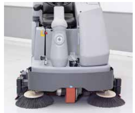
Les brosses latérales rétractables sur les modèles cylindriques éliminent efficacement les débris
