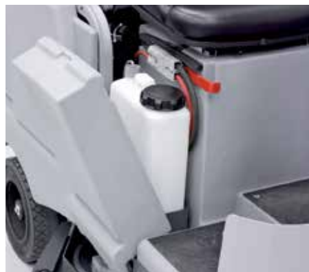
Les cartouches de détergent faciles d'accès sont l'une des caractéristiques du système Ecoflex
