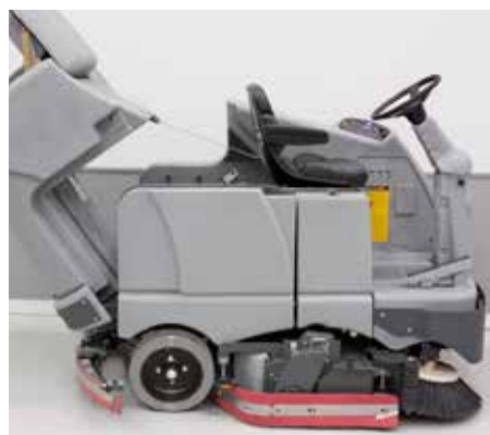
Le réservoir de récupération basculant pour un nettoyage simple et rapide et permettant un accès facile au compartiment batterie
