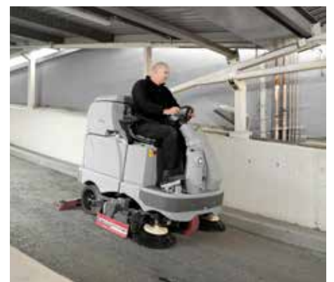
Le moteur de traction puissant et l'excellente force de traction permettent de l'utiliser sur des rampes et des pentes inclinées jusqu'à 16 %
