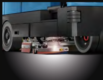
Brosse latérale droite de lavage avec aspiration
