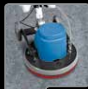
Entretien à sec: décirage et cirage de sols en vinyle
