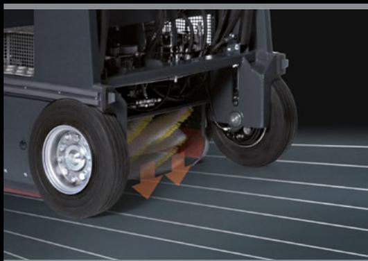
La brosse centrale est flottante et auto-réglable de manière à rester en permanence en contact avec le terrain
