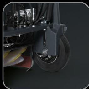
Les roues de grand diamètre non seulement réduisent les contraintes mécaniques mais favorisent aussi le confort. Leur support robuste aide à préserver les caractéristiques de fonctionnement inaltérées dans le temps. Les deux versions sont équipées en série de freins à commande hydraulique
