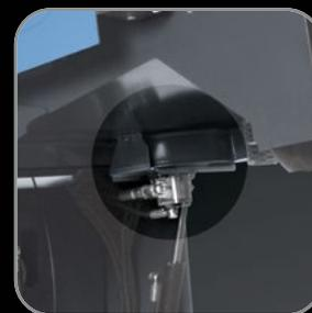
La turbine d'aspiration, appliquée directement sur le bac de ramassage des déchets et actionnée par le moteur hydraulique, assure la continuité des performances dans le temps
