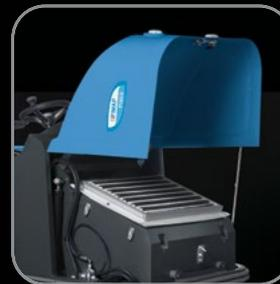
Aucun entretien grâce à l'utilisation périodique du secoue-filtre électrique
