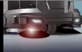
2 brosses latérales de balayage augmentent les performances de nettoyage le long des murs (disponible pour les versions Cylindrical)
