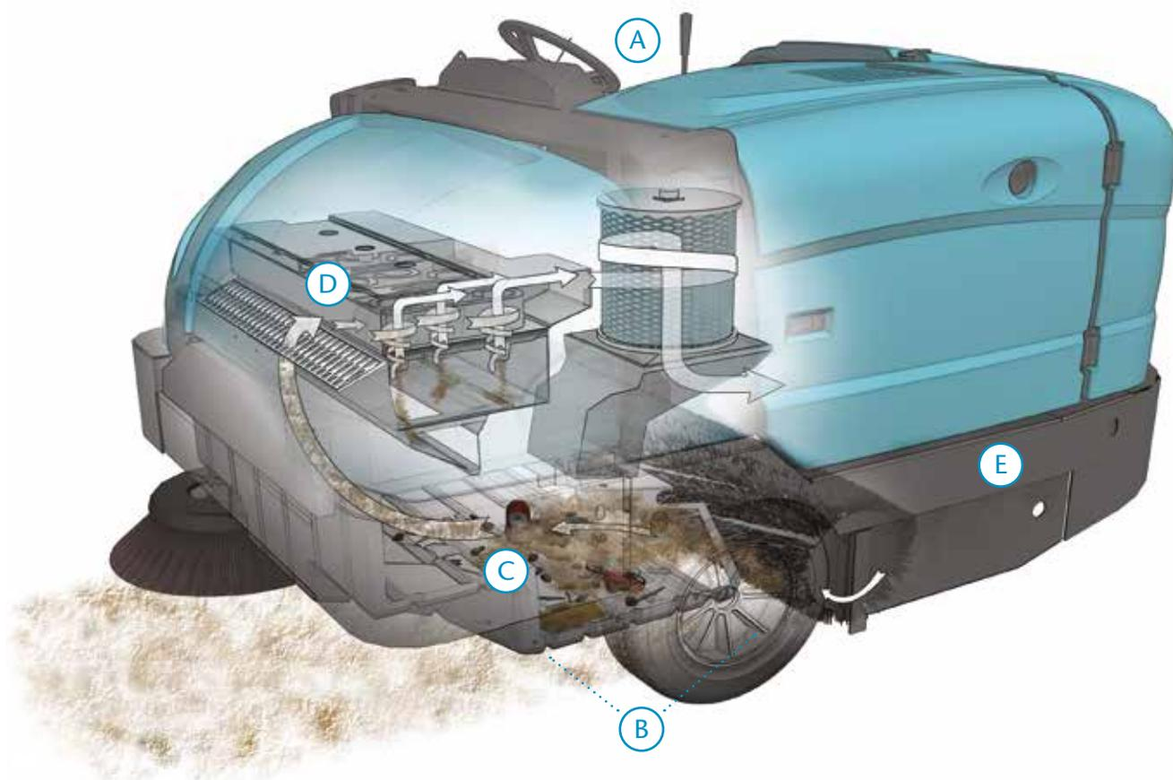
**A** Éliminez de manière efficace différents types de débris, avec le système de balayage II-Speed™. Ce système augmente de 20% la vitesse de la brosse principale, de la brosse latérale et de la turbine d'aspiration.
